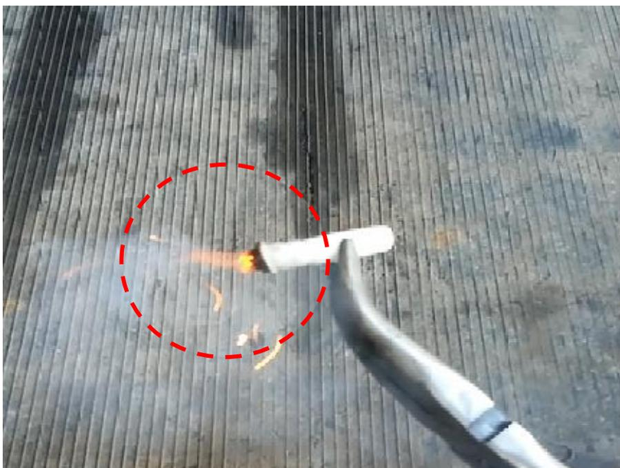
**Foto 12** – Estopim Hidráulico, durante o teste de eficiência
