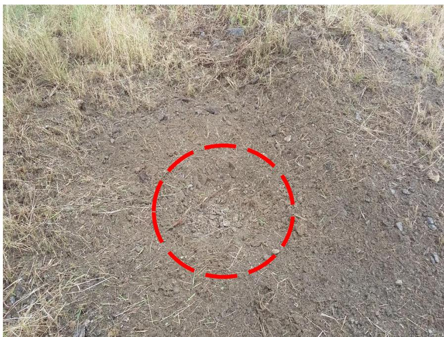
**Foto 19** – Resultado da detonação do Explosivo durante teste de eficiência, 1,150 kg
