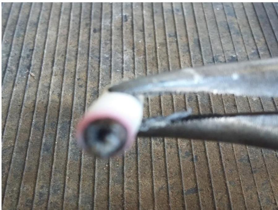
**Foto 11** – Estopim Hidráulico, posicionado para teste de eficiência
