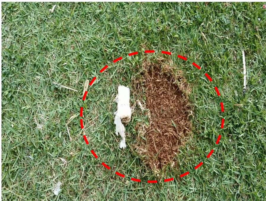
**Foto 16** – Resultado da detonação do Explosivo durante teste de eficiência, 190 Gramas
