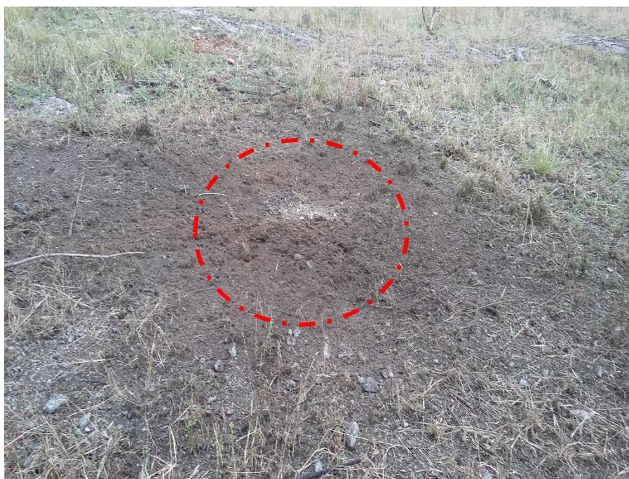
**Foto 23** – Resultado da detonação do Explosivo durante teste de eficiência, 2,460kg
