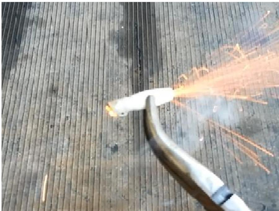
**Foto 13** – Estopim Hidráulico, queima total, teste de eficiência, chispa suficiente para acionar a espoleta.
